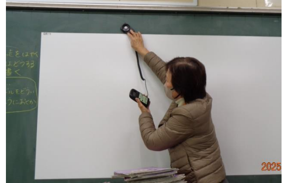
【照度検査の様子】
